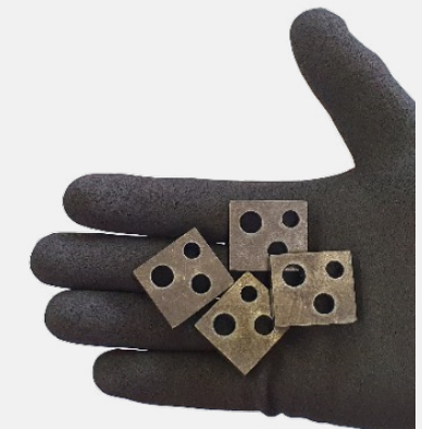
Plasmaschneiden kleiner Löcher
