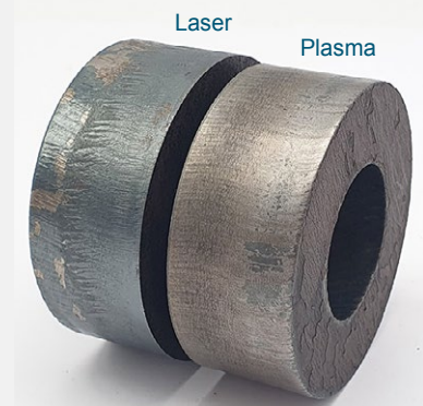
Vergleich Schnittflächen 25 mm Baustahl
