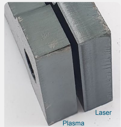
Vergleich Schnittflächen 10 mm Baustahl
