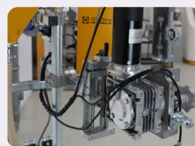
Robustes Vorschubgetriebe für Draht bis Ø 5,0 mm
